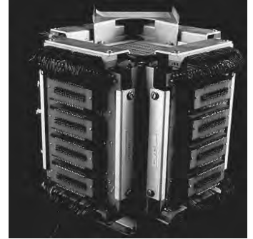
Bild 6/39: Mit dem Aufbau von Magnetkernspeichern (Core-Memory) konnten platzsparende Arbeitsspeicher realisiert werden.
